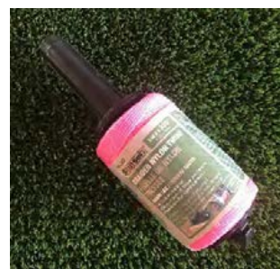
Corde à maçonnerie
